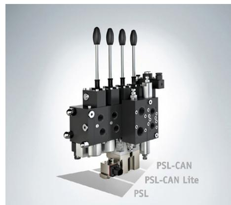
PSXCAN Tool con il quale è possibile la modifica e l'esportazione dei parametri ed il loro monitoraggio. Per la valvola a spola direzionale tipo PSL si possono implementare pressioni di esercizio fino a 420 bar e un campo di portata da 1 a 240 l/min in 3 dimensioni costruttive che possono essere combinate in un unico banco di valvole.
