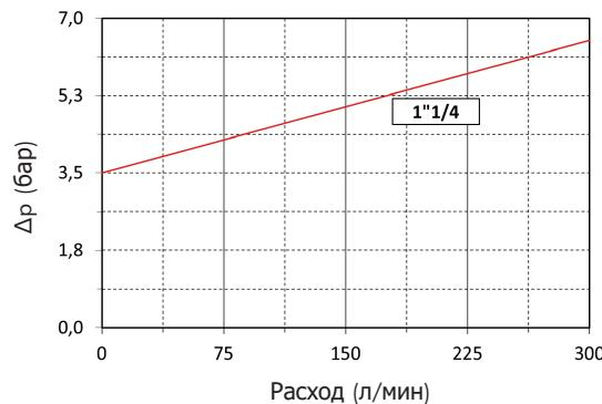
Примечание. Все приведенные данные получены в нашей лаборатории, в соответствии со Спецификацией ISO3968, с использованием минерального масла вязкостью 32 сСт и плотностью 0,875 кг/дм<sup>3</sup>.
