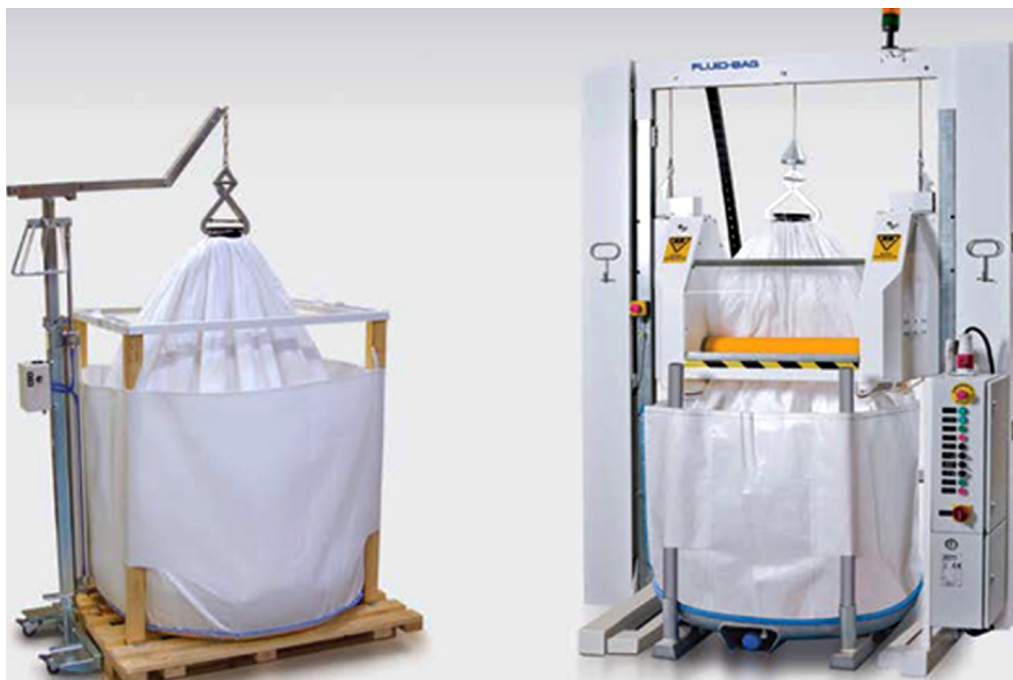
Figura 14 - Fase di svuotamento con allungamento e schiacciamento con rullatura per svuotamento spinto (Fluid-Bag Ltd - Solving Italia)
