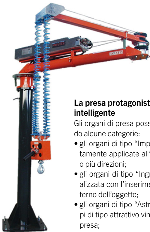
Figura 9 - Manipolatore ATIS ACER ad ingombro ridotto, dotato di un sistema di rinvio a funi con cilindro pneumatico e organo di presa intercambiabile anche per oggetti particolari (Atis S.r.l.)
